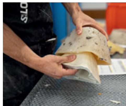
... und das Aus-der-Form-Lösen.
